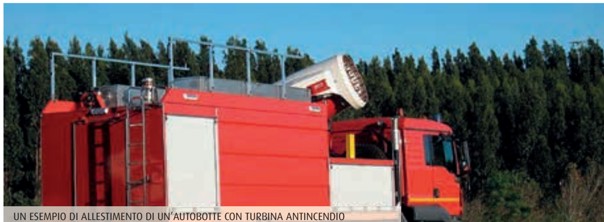
UN ESEMPIO DI ALLESTIMENTO DI UN'AUTOBOTTE CON TURBINA ANTINCENDIO
