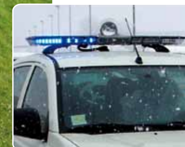
Barra INTAV incorporata faro di ricerca radiocomandato
