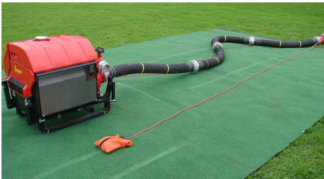
Figura 15: collocazione del sacchetto con il cordino della valvola di fondo
