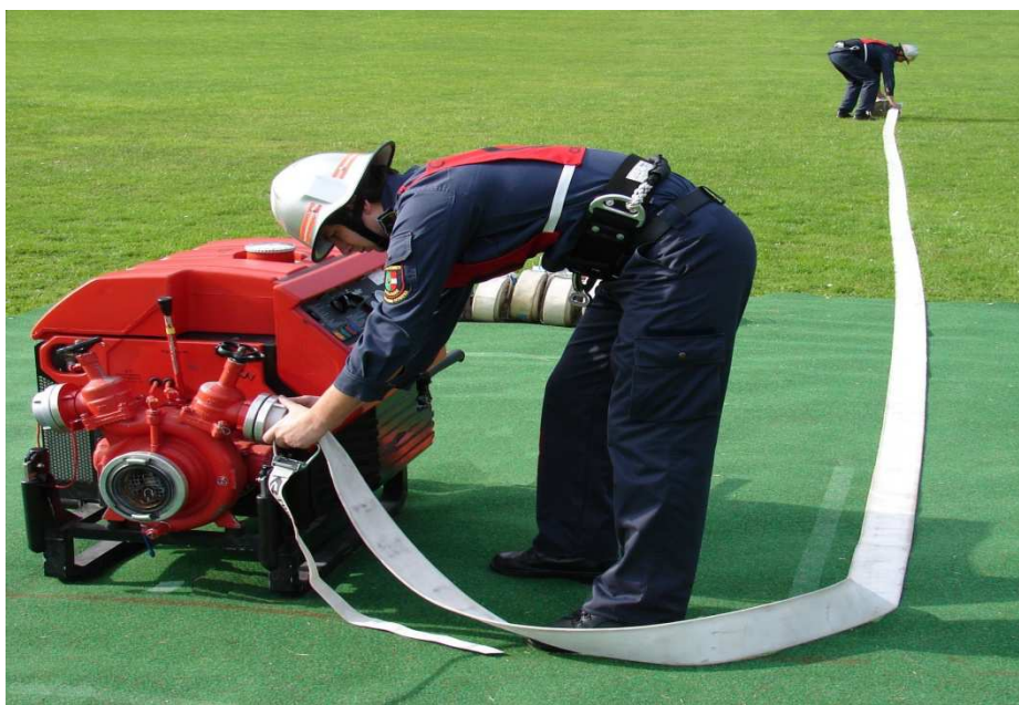
Figura 17: collegamento e stendimento della prima manichetta B
