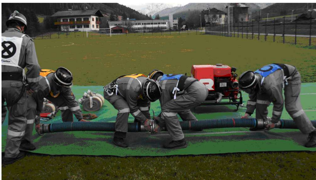
Figura 7b: collegamento dei tubi d'aspirazione da parte dell'unità d'alimentazione e dell'unità di stendimento
