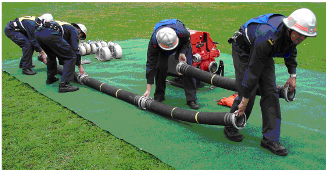
Figura 4b:disposizione dei tubi d'aspirazione da parte dell'unità d'alimentazione
