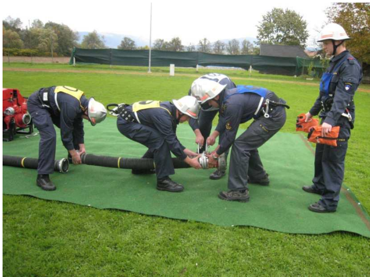
Figura 5: presa del primo tubo d'aspirazione per collegare la succhieruola
