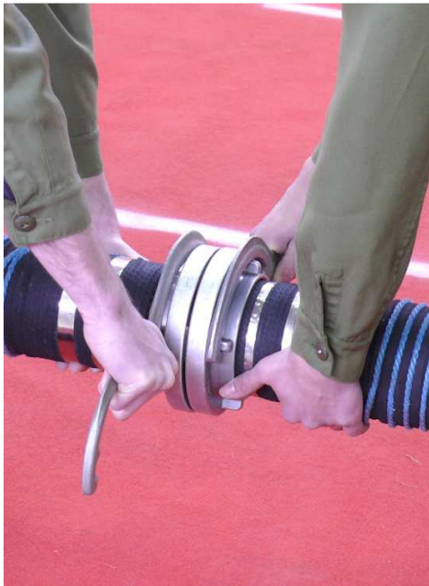
Figura 8b: applicazione della chiave stringitubo e collegamento dei tubi
