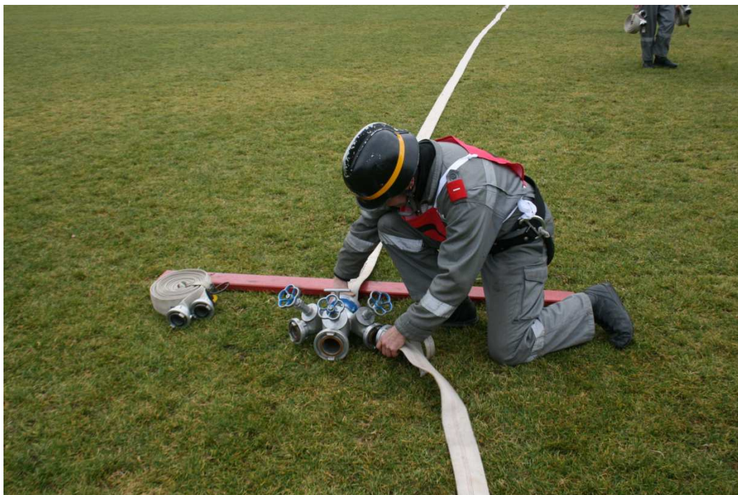
Figura 20: collegamento della manichetta C e B al divisore
