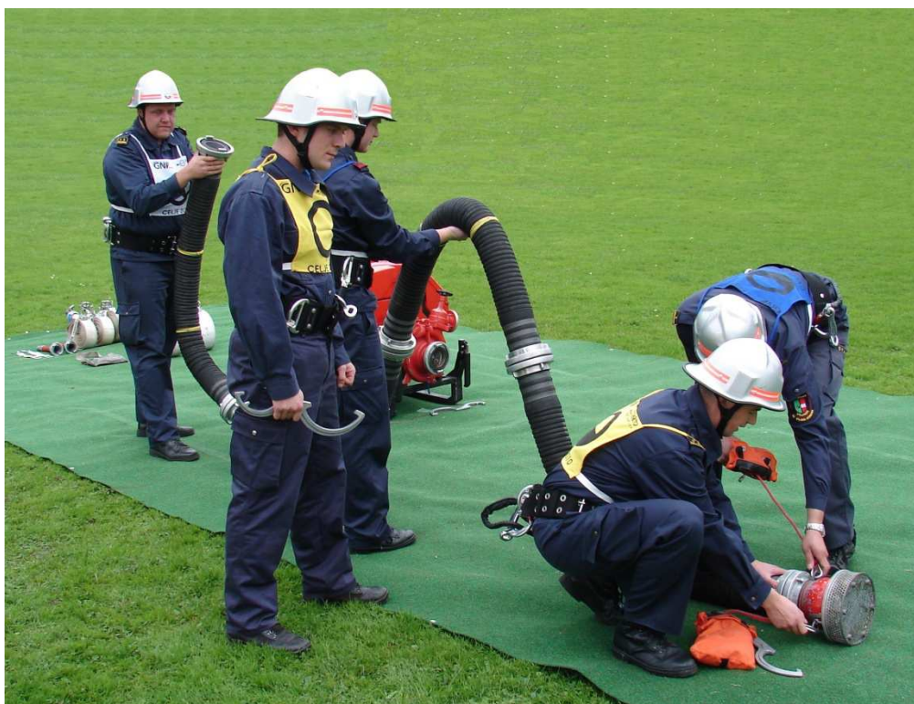
Figura 11: sollevamento della linea di aspirazione collegata, posa del tubo d'aspirazione e del cordino della valvola di fondo
