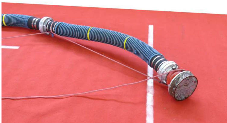
Figura 13: posa della succhieruola al di là dell'assicella
