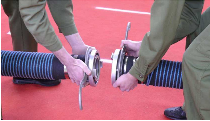
Figura 8a: applicazione della chiave stringitubo e collegamento dei tubi
