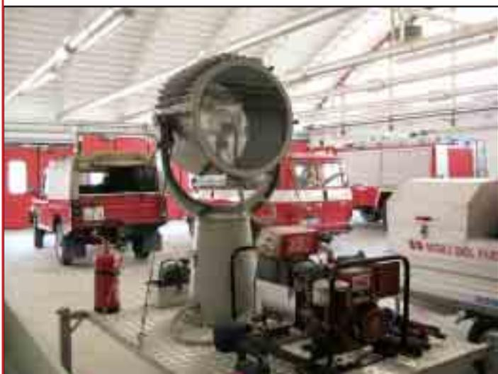
nare la parete (Via Boomerang) con il potentissimo fascio di luce. Questa fotoelettrica è un moderno riflettore che consente la diffusione e la concentrazione del fascio luminoso, grazie ad una parabola in vetro al quarzo argentato, che permette un fascio di luce concentrato e perfettamente parallelo,
